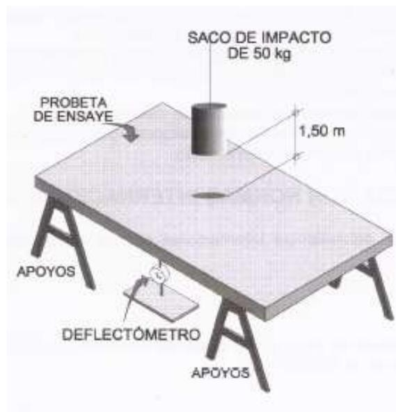
Fig. 9 Resistencia al impacto en pánels tipo II
